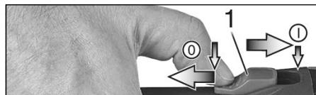
**Mise en marche/arrêt** : pousser l'interrupteur coulissant (1) vers l'avant. Pour un
