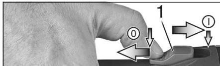
**Conexión/Conexión permanente:** desplace la corredera comutadora (1) hacia adelante conexión constante. Para un funcionamiento continuado, muévalo hacia abajo hasta que quede encajado.
